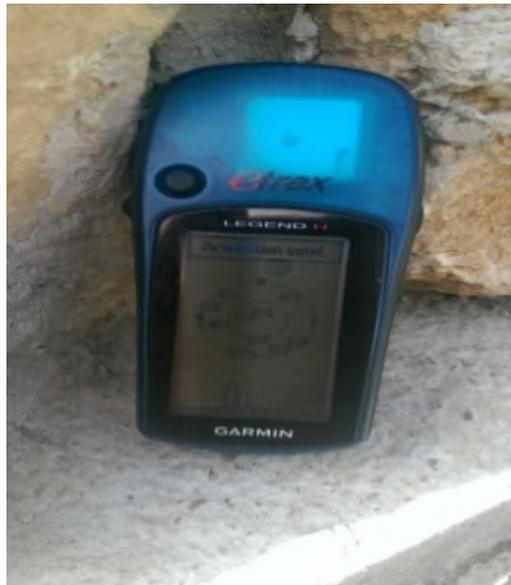
Figure N°12 : Le GPS (eltrex /GARMIN/1JZ049472can310).
