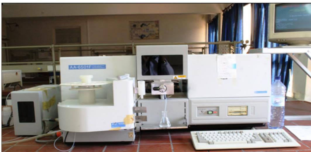
**Figure N°19 :** Le spectromètre d'absorption atomique en flamme (AA-6501F/SHIMADZU)
