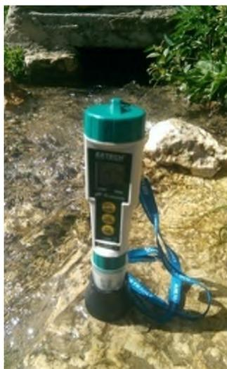
**Figure N° 18 :** Multi paramètres de terrain (EXTECH Instrument EC510).
