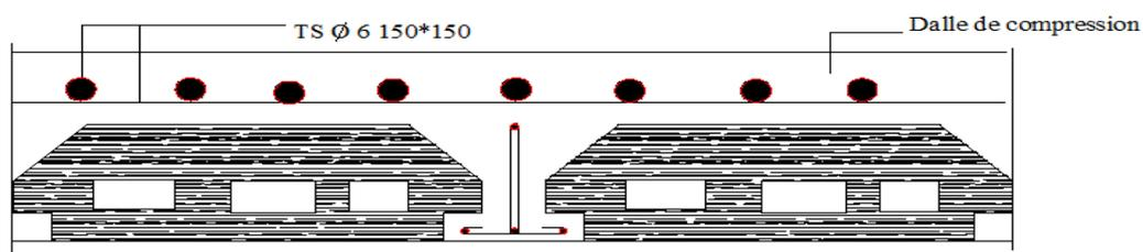
**Figure .III.3 :** Ferrailage de la dalle de compression.
