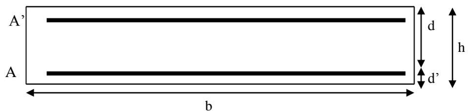
Figure IV.10 Dimensions du mur frontal.
