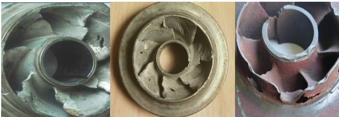
Fig (IV.2) : Roues soumises à la cavitation.
