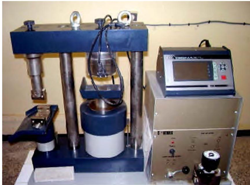
**Figure II.19.** Machine de compression et flexion sur les ciments (Control) type 65-113M1.
