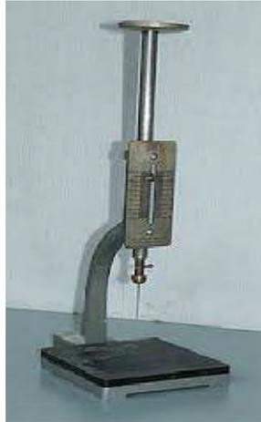
Figure II.20. Appareil de Vicat.
