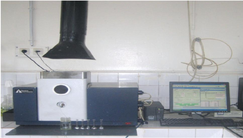
**Figure II.14.** Photo de l'appareille du spectrophotomètre d'absorption atomique.
