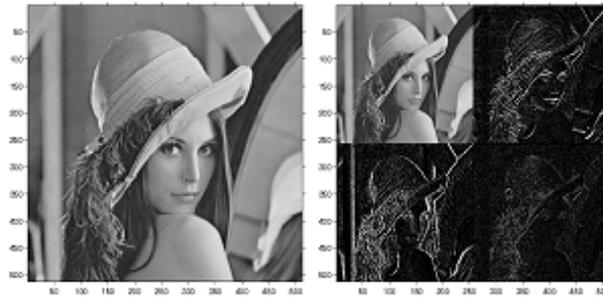
Figure 17 : Exemple de décomposition en ondelettes d'une image au premier niveau de résolution
