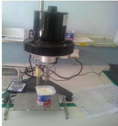
**Figure 12 : Viscosimètre Brookfield.**
