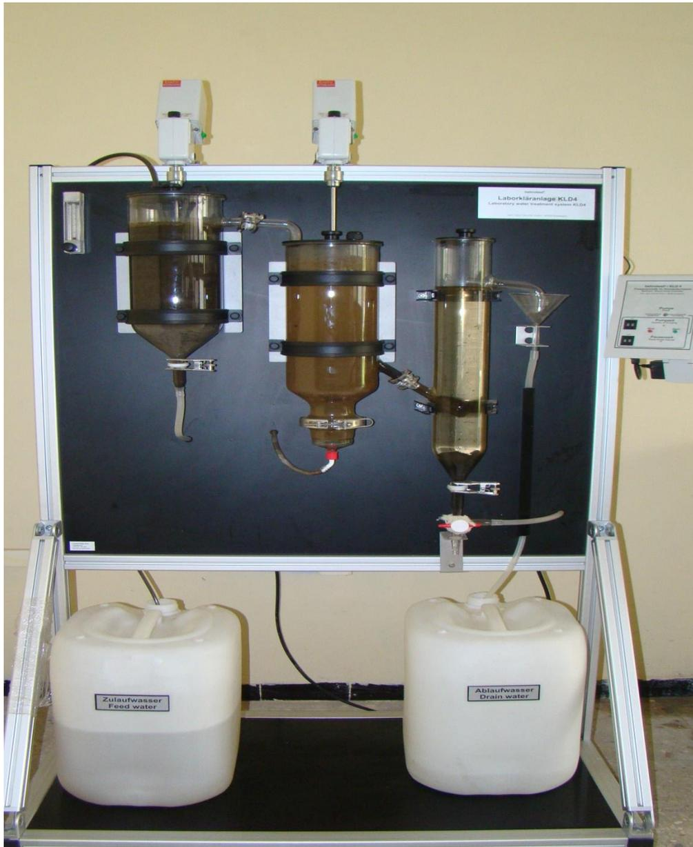
**Figure IV-20 : Réacteur biologique avec étage préliminaire de dénitrification**
