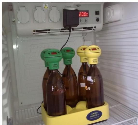
Figure IV-27: DBO mètre type OXITop® IS 6
