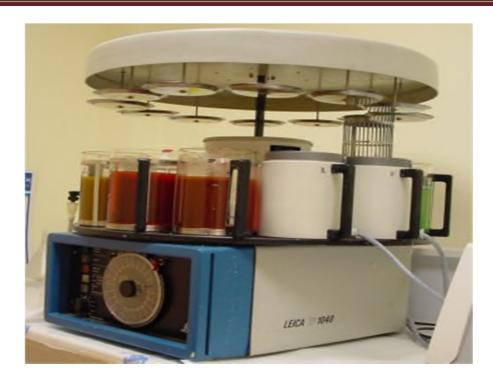
Figure 9: Automate LEICA (photo prise au CHU Mustapha Bacha, Alger)
