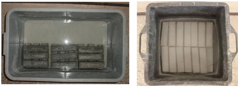
Figure II.6 : Immersion des mortiers dans l'eau
