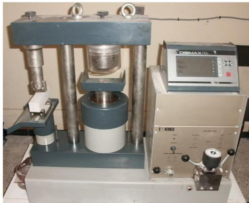
**Figure II.4: machine d'essais de résistance à la compression.**
