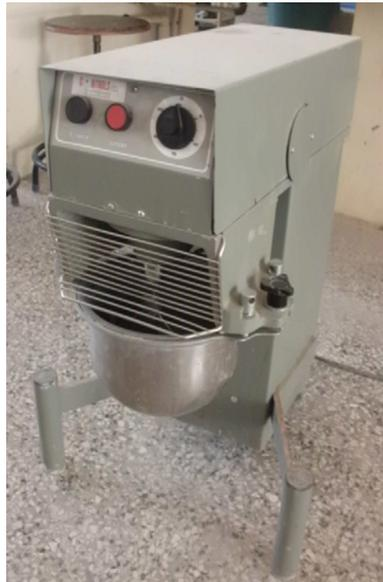
**Figure II.1 : malaxeur normalisé pour pâte et mortier.**
