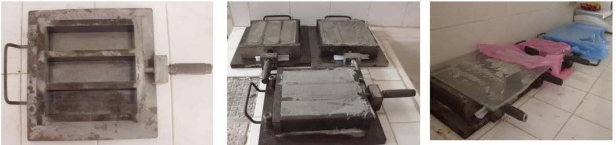
**Figure II.2: Moules pour moulage des éprouvettes de mortier.**
