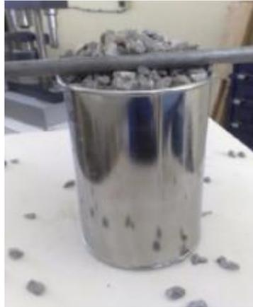
**Figure 2.11 : Masse volumique apparente.**
