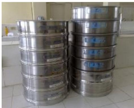
**Figure 2-2 : Colonnes de tamis.**
