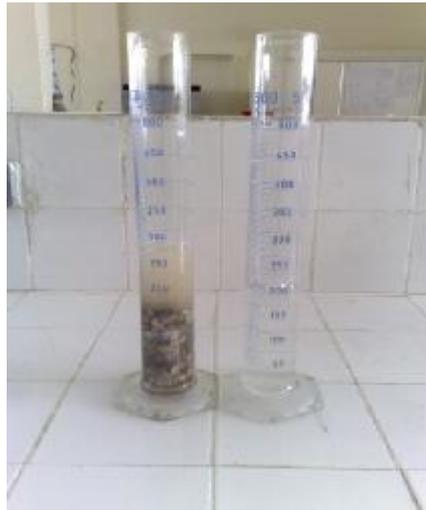
**Figure 2.12 : Mesure de la masse volumique absolue.**
