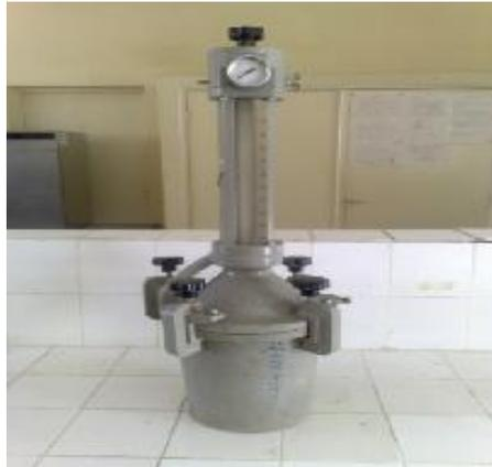
**Figure 3-9 : Aéromètre.**
