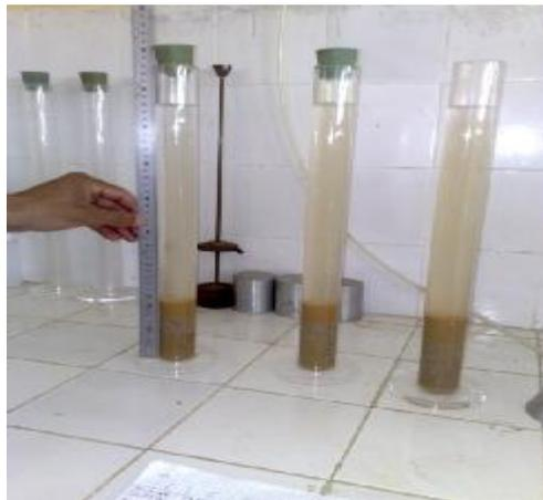
Figure 2-9 : équivalent du sable.
