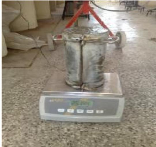
Figure 3-10 : mesure de la masse volumique fraiche.
