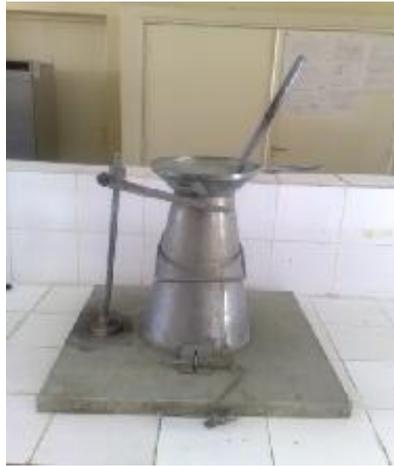
**Figure 3-6 : cône d'ABRAMS.**
