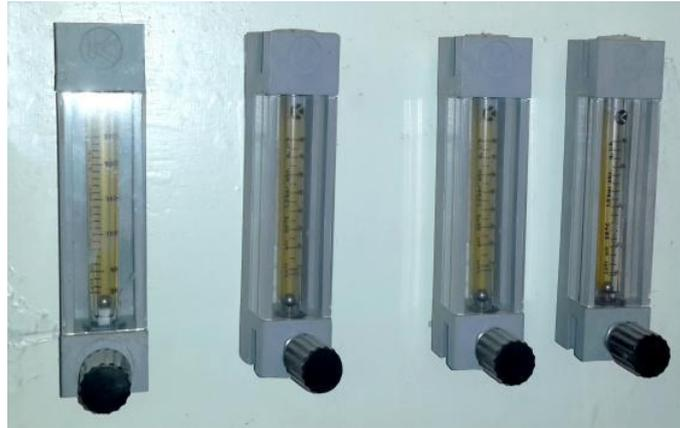
**Figure III.8 :** Débitmètres à air placés en parallèle
