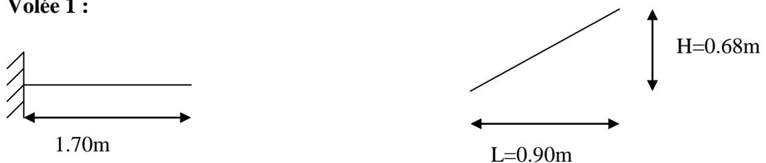
Figure V.5 : schéma statique de la volée 1.
