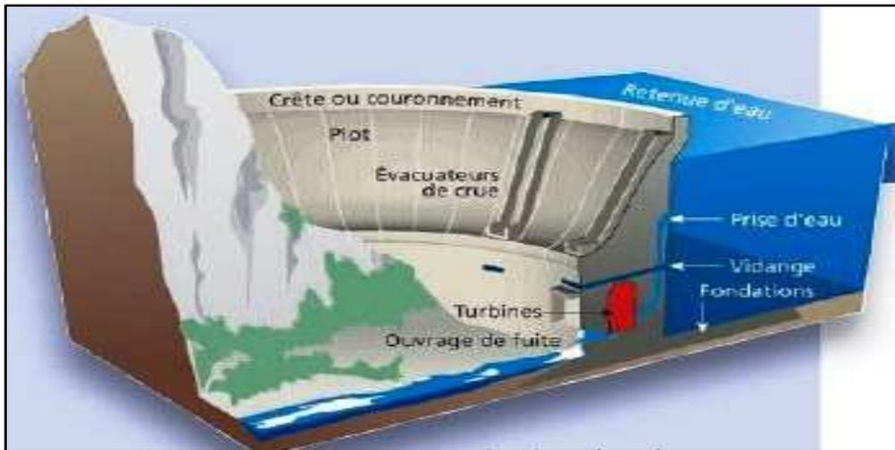
Figure 12- Ouvrages annexes d'un barrage
