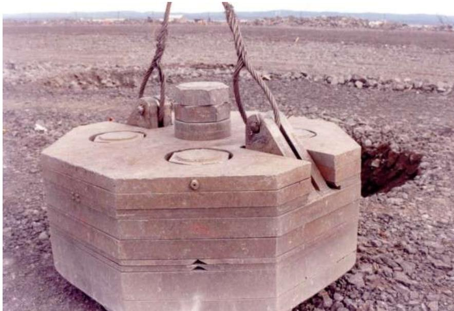
**Fig II.4 :** Exemple d'un pilon [10]
