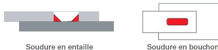
Figure 1.36. Soudure en bouchon et soudures en entaille.
