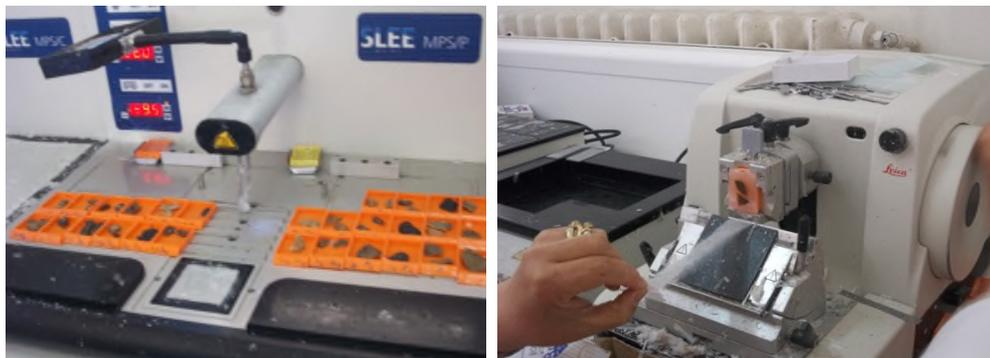
**Figure 15:** Distributeur de paraffine à gauche et réalisation des coupes au microtome LEICA RM 2145 à droite (CHU Bejaia, 2014).
