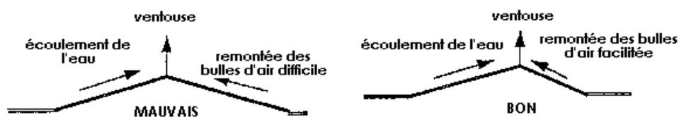
Figure (III-1) : L'emplacement préférable des ventouses
