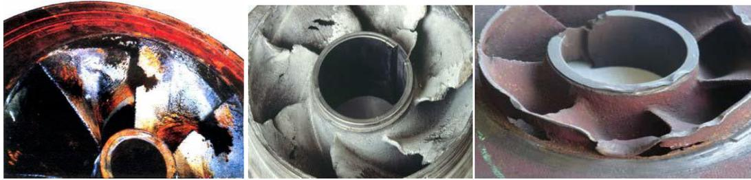
Figure (IV-10) : Érosion par cavitation sur les aubes d'une pompe centrifuge.
