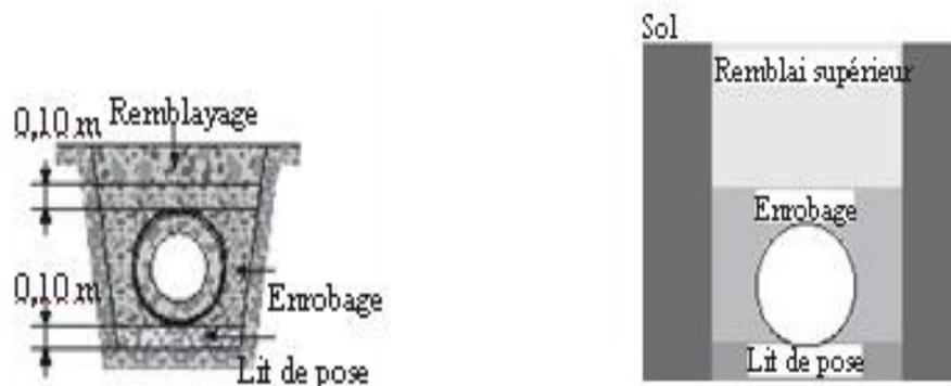
*Figure (VIII-3) : Pose de la conduite en tranchée.*
