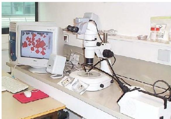
**Figure (III-4) : Système d'analyse d'image; Ordinateur et logiciel d'analyse, camera, Binoculaire et fibre optique.**
