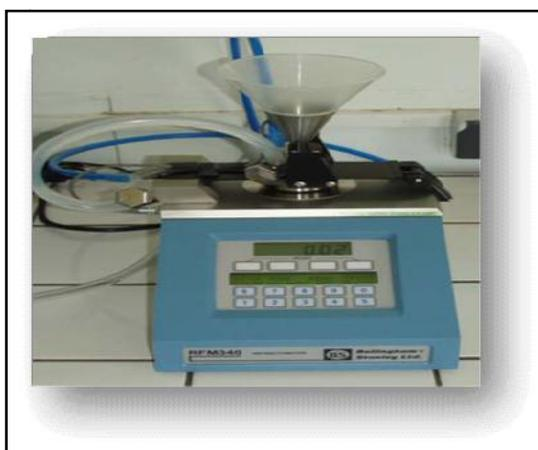
**Figure (III-1): Réfractomètre électronique**
