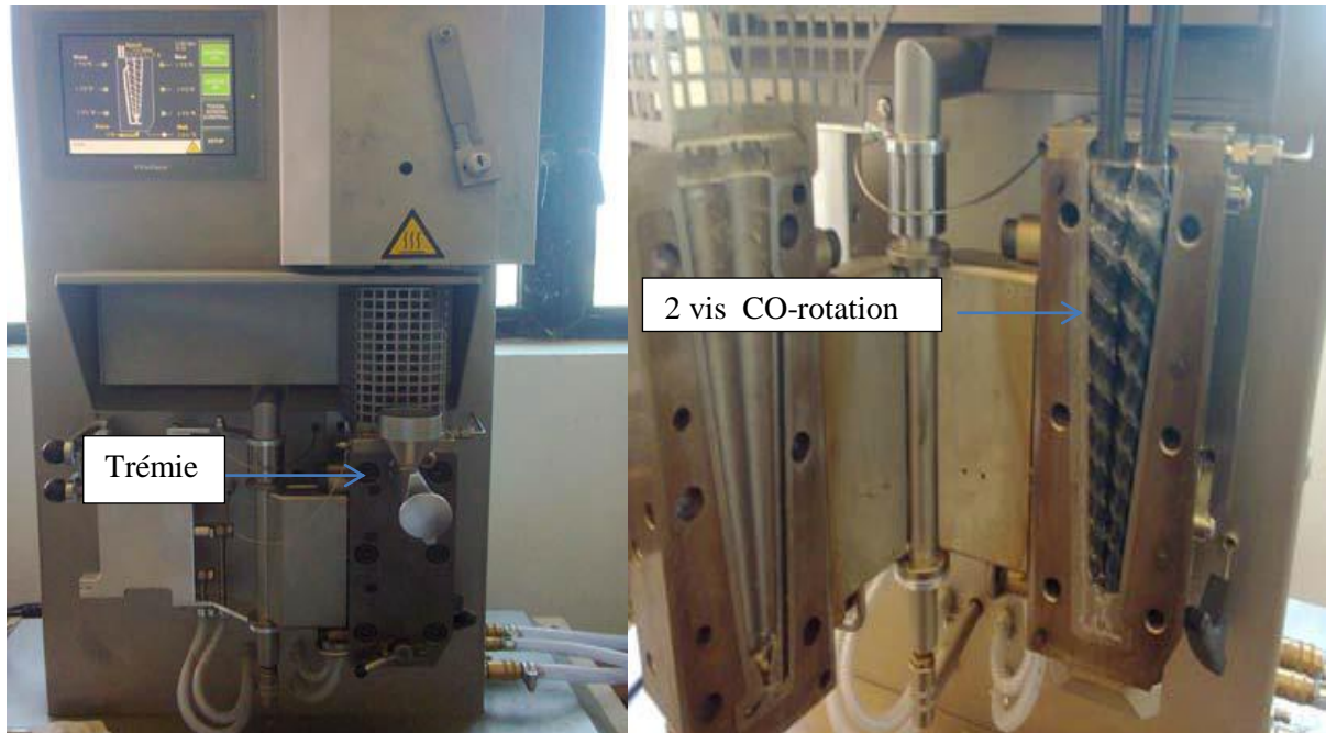
Figure IV-3 : Photographie de la micro - extrudeuse bi-vis utilisée.
