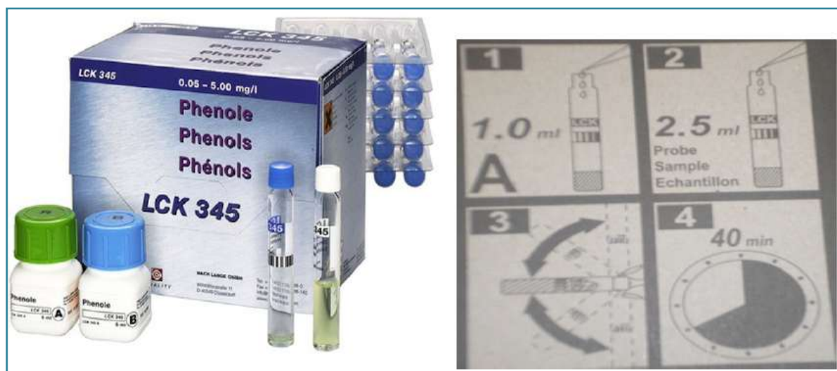
Figure IV.23 : Boîte LCK et le mode opératoire
