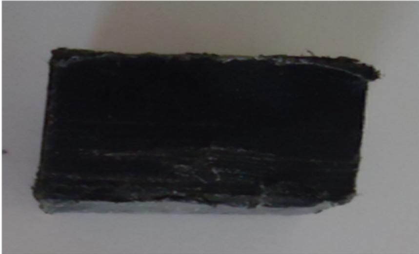
**Figure VI.48 : Image d'un plot en PE avec déposition du tartre.**
