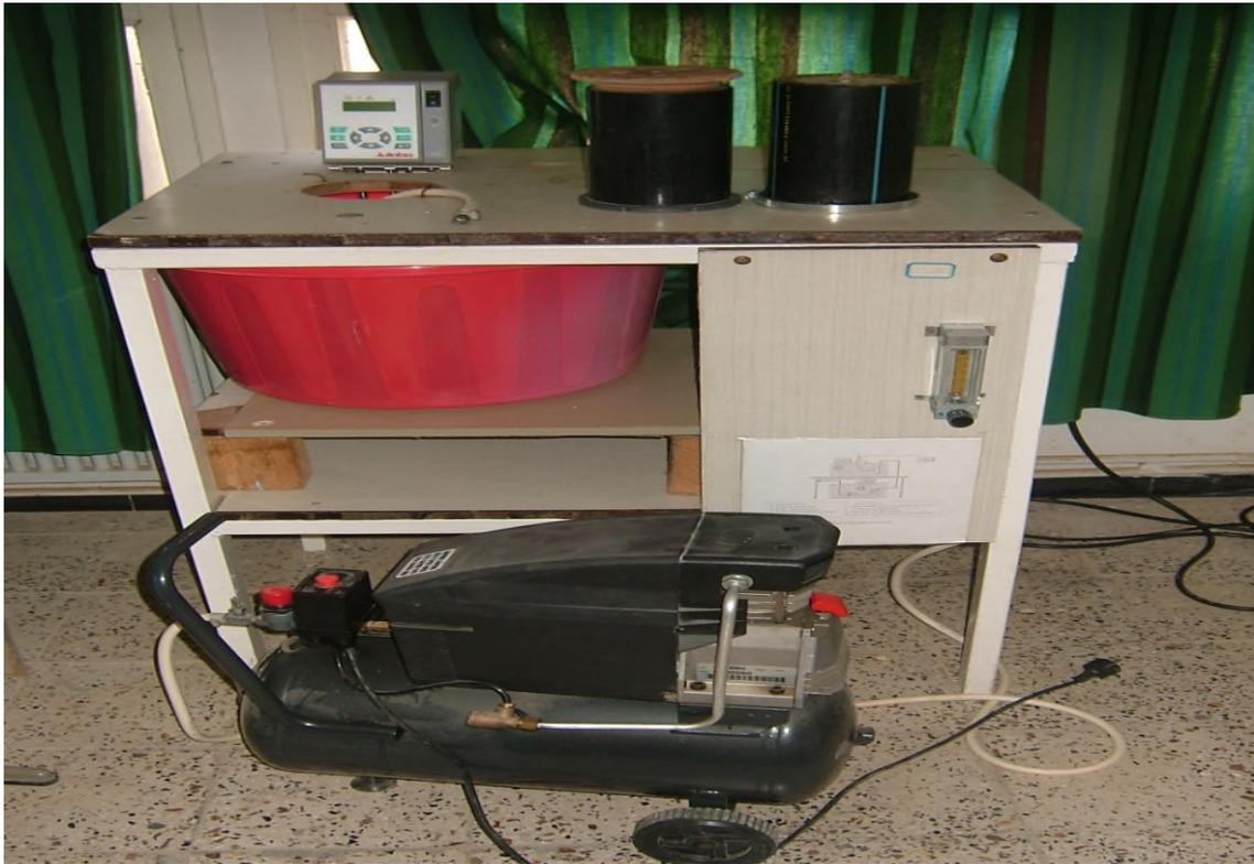
**Figure V.2 : Photo du dispositif expérimental de la Technique de Dégazage Contrôlé.**
