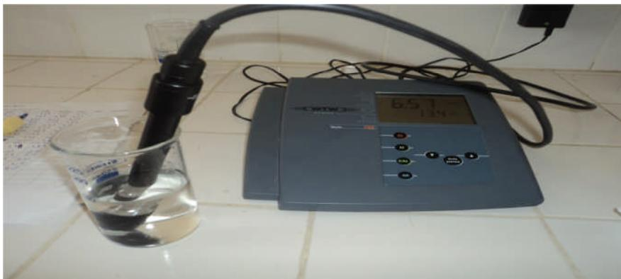
**Figure N°6** : Le multiparamètre (inoLAB\* pH/ION/Cond 750)
