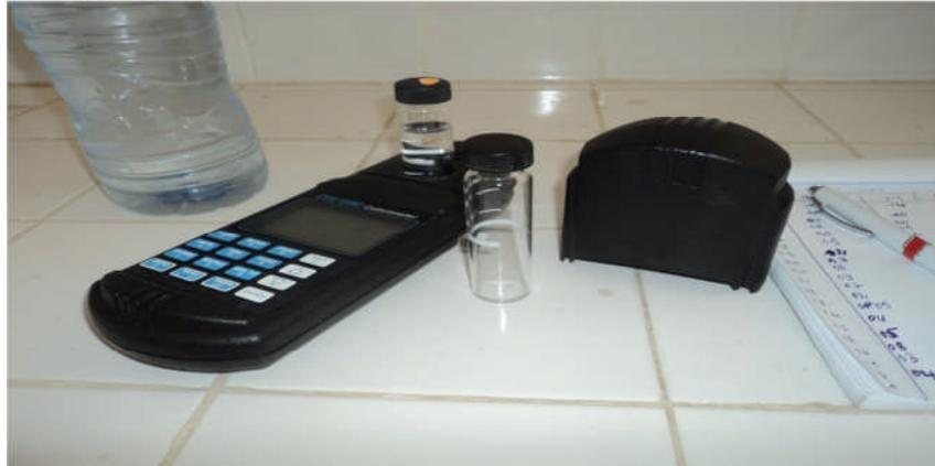
**Figure N°5** : Le colorimètre (HACH HD/890)
