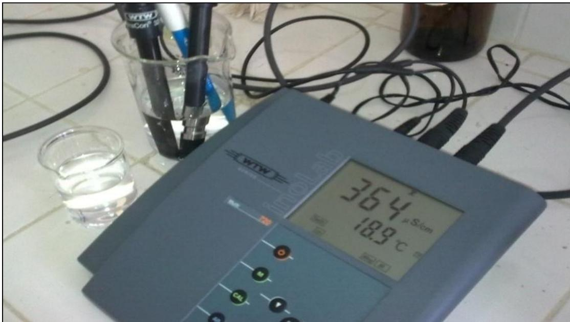
**Figure II.1 :** Photo du multi-paramètre (inoLAB\* pH/ION/Cond 750).
