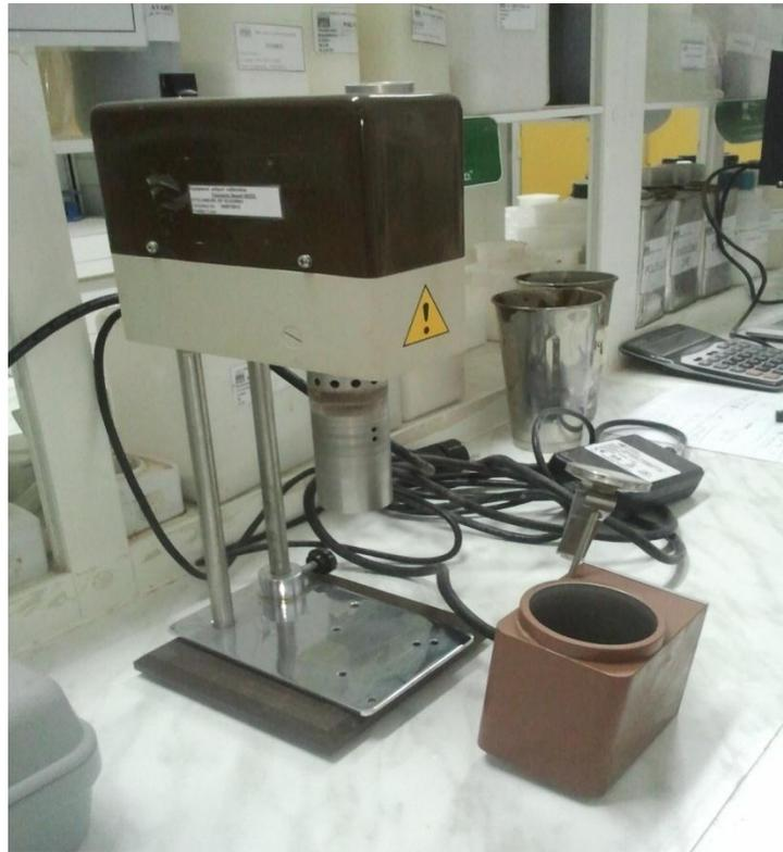
**Fig. I.1 (Viscosimètre OFITE model-800 à 8 vitesses).**
