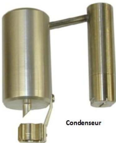
Fig. I.8 condenseur du distillateur
