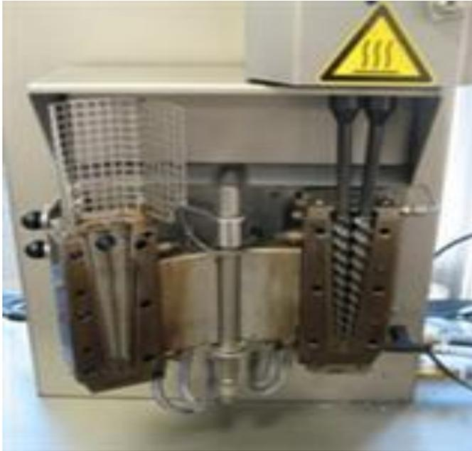
**Figure 20:** Extrudeuse bis-vis de type micro compounder DSM Xplore modèle 2005
