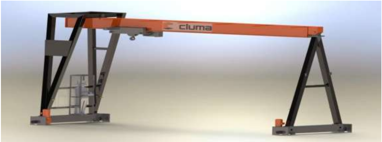
Figure I.9: Portique mono poutre.
