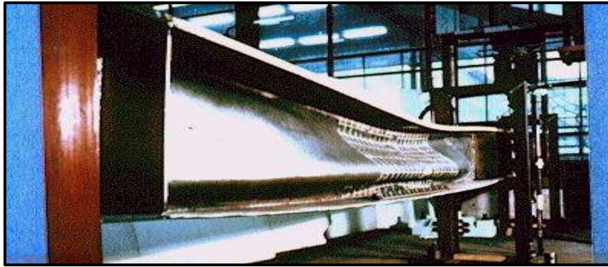
Figure II.3: Flambement d'une poutre.
