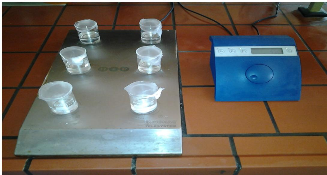
**Figure II.2 : Agitateur multiposte type Variomag télésystem**
