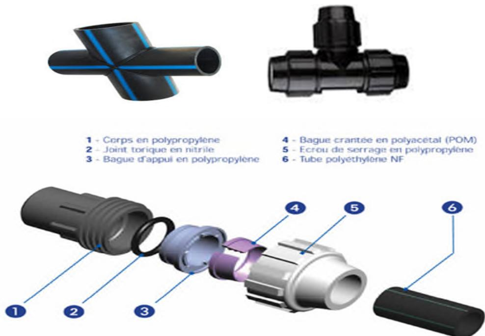
*Figure(V.4): les raccords des conduites en PEHD*
