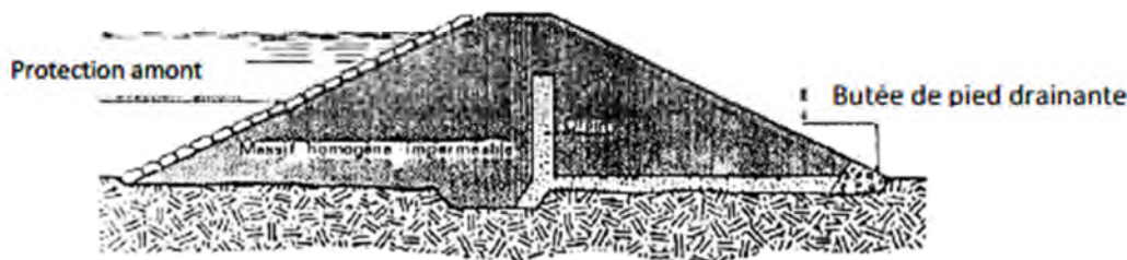
Figure (II.3) : Barrage en terre homogène
