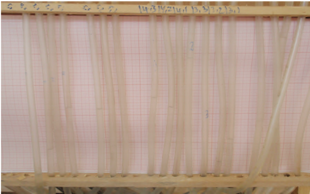
Figure (III.10) : Les piézomètres de lecture
