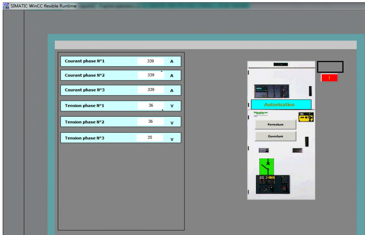
Figure III.2: Vue autorisation de fermeture cellule F06 sans synchronisation
