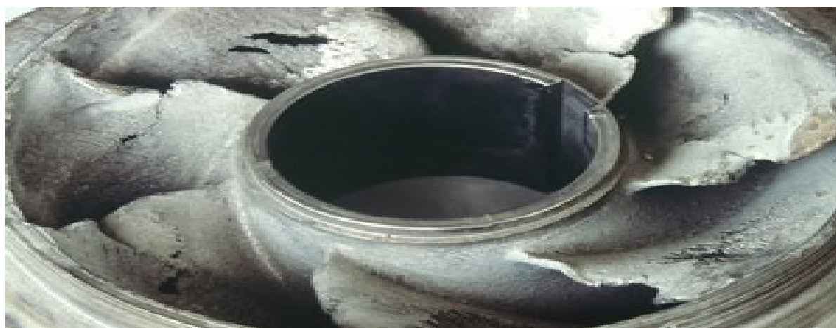
Figure (V-6) : Roue soumise à la cavitation.
