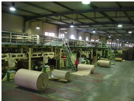
FIGURE 1.3 – Arrivage des bobines de papier devant l'onduleuse Général Emballage
