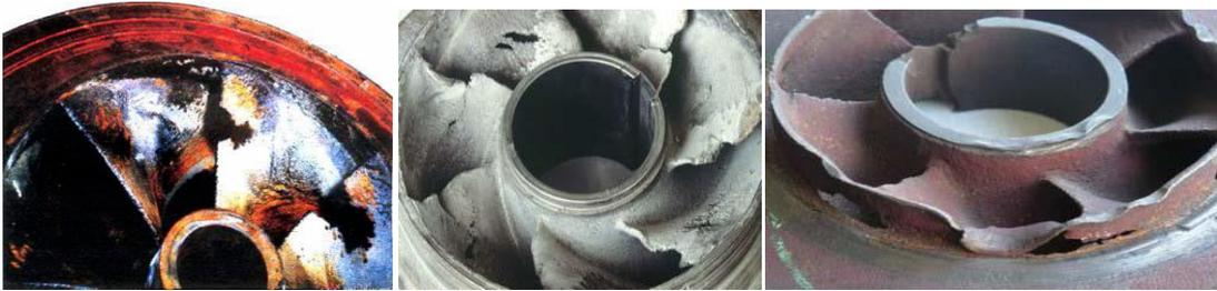
Figure (IV-11) : Érosion par cavitation sur les aubes d'une pompe centrifuge
