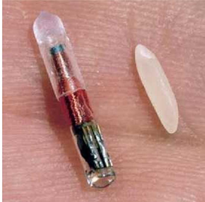
Figure 1.4 – Tag RFID passif comparé à un grain de riz
