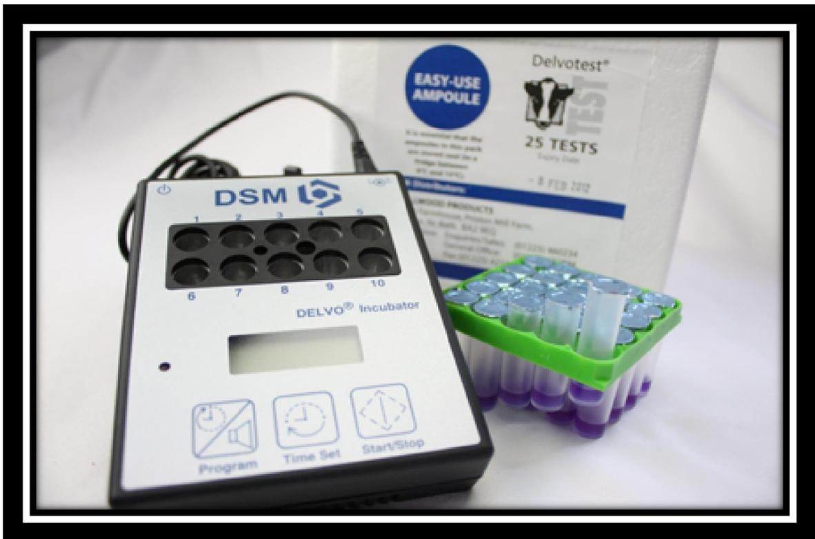
Figure 3: Test d'antibiotique Delvo test (DELVO®- incubateur).
