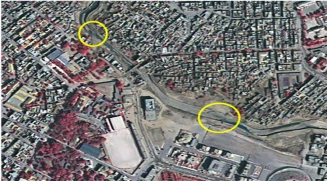
*Figure II.19: Impacts de l'inondation identifiés sur les images du satellite Kompsat (©KARI), matérialisés par la destruction de deux passerelles (cercle en jaune).*
