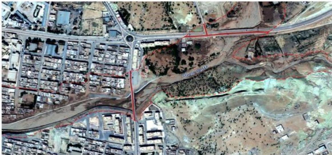
*Figure II.20 : La délimitation de la zone inondée réalisée à partir des Images du satellite Worldview-2*
