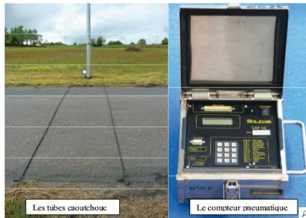
FIG 2.8 – Capteur pneumatiques
