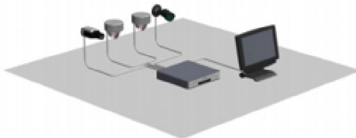
FIGURE 1.7 – Exemple du système de vidéosurveillance analogique
