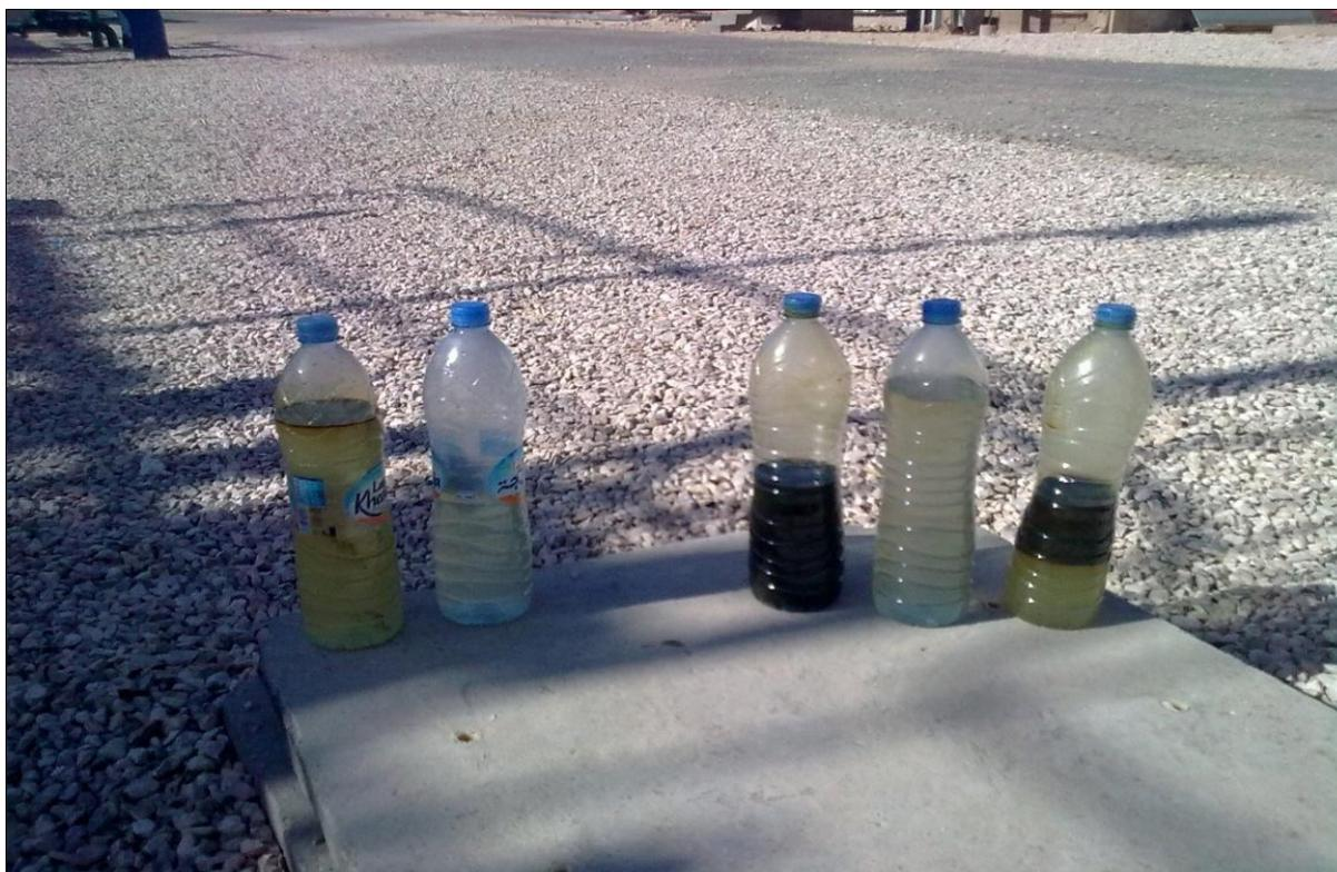
**Figure IV.5** : Les échantillons d'eaux huileuses (photo prise le 22/03/2016)
