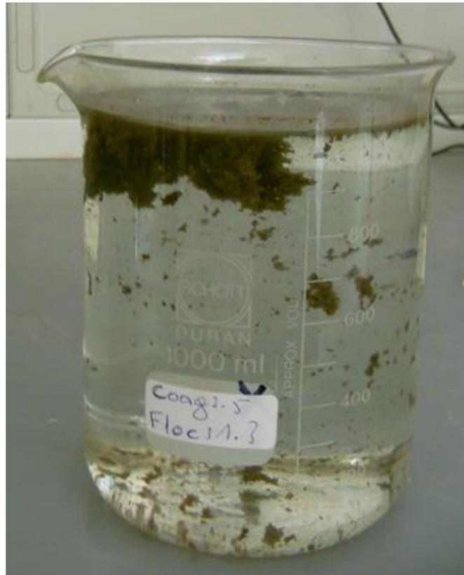
**Figure IV.33 :** Echantillon d'eau huileuse après l'injection de la dose coagulant=3,5 ml et floculant = 1,3 ml (photo prise le 23/04/2016)
