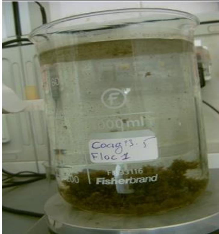
**Figure IV.28 :** Echantillon d'eau huileuse après injection de la dose du flocculant= 1 ml
