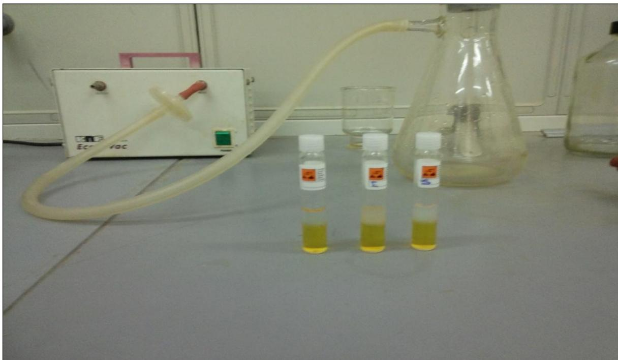
**Figure IV.11:** Fioles à Réactif Digestive pour DCO (photo prise le 23/03/2016)
