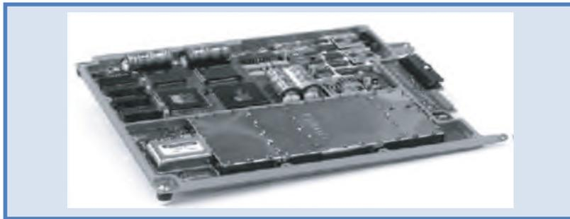
**Figure 3.9** : l'intérieur d'un récepteur GPS militaire
