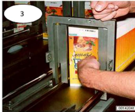
Fig.III.5 L'étape finale des fixations des briques sur les voies.
