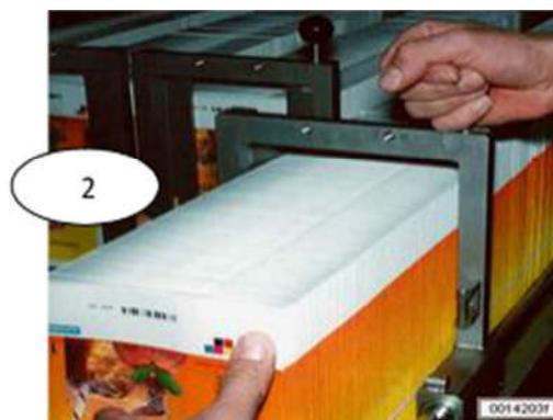
Fig.III.4 Positionnement des briques sur les voies
