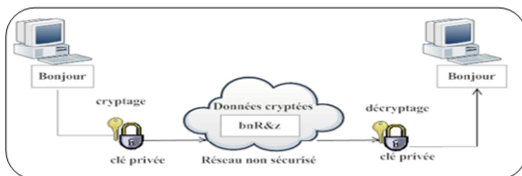
FIG. II.1 – Principe du chiffrement symétrique
