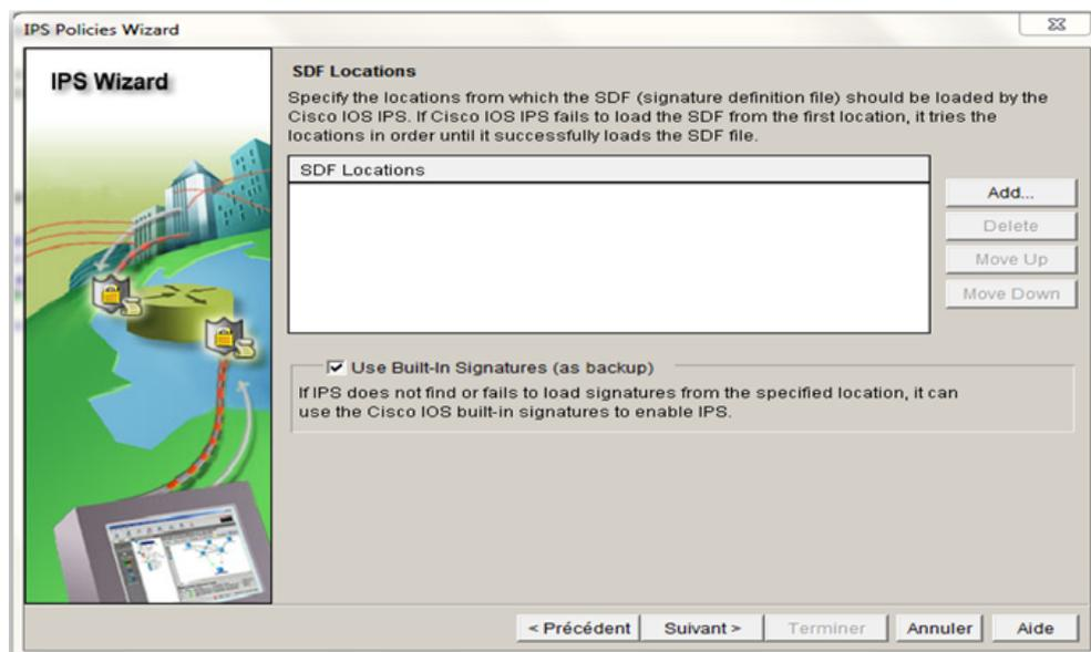
Pour additionner les signatures à l'endroit du SDF, on doit tout d'abord les télécharger sur la mémoire flash du Routeur via l'application TFTP (Trivial File Transfer Protocol).
