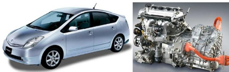
FIGURE 1.18 – Toyota Prius 2 et son système motopropulseur" Toyota Synergy Drive"
