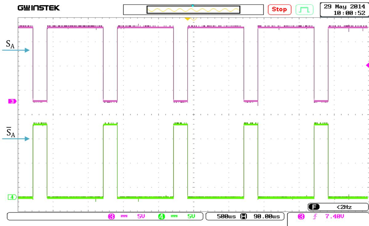
Fig.IV.18. Les signaux de commande  $S_a$  et  $\bar{S}_a$  de l'onduleur (commande 180°).
