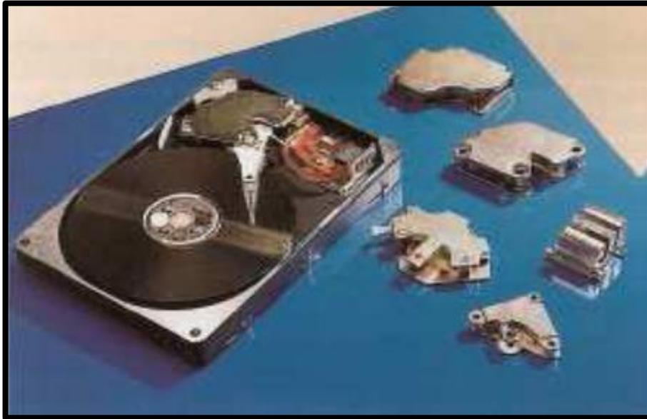
**Figure I.10.** : Disque dur d'un ordinateur.
