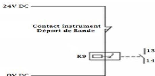
**Figure I.5** : Schéma de principe de la sécurité "Déport de bande" [Cev 15].
