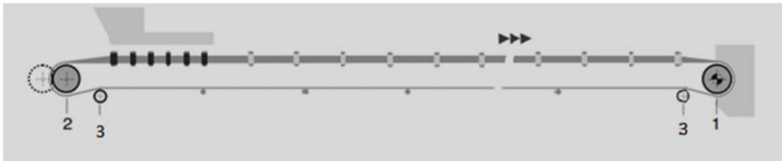
**Figure II.13** : Présentation des différents tambours du convoyeur [Con 09].
