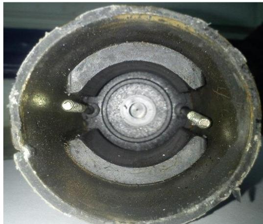
Figure III.17-Le stator (inducteur)
