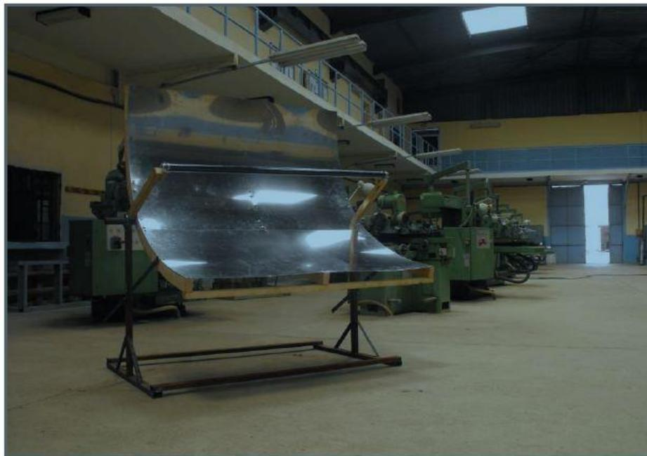
Figure.III.12-vue du concentrateur réalisé sans languettes de miroir.
