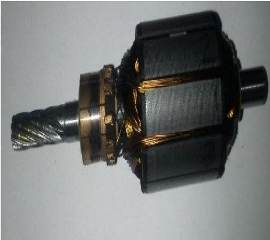
Figure III.16-Le rotor (induit)
