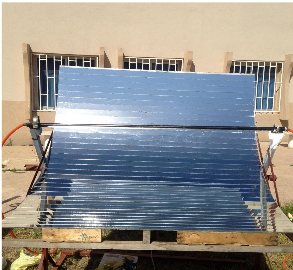
Figure III.13-le concentrateur réalisé avec des languette de miroir.
