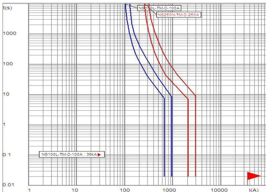
Figure IV.5 : Courbe de sélectivité entre les disjoncteurs  $D_{c1}$  et  $D1$
